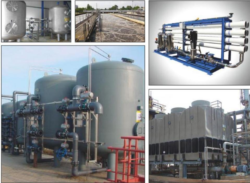
地下水除铁锰。PH在6-10左右的水中去除铁、锰、砷、镭、硫化氢、重金属、氟化物，以及与其他滤料配合吸附去除硼、氟化物等。
