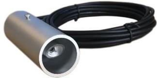
HY-IRS2内部是由一个热电堆和一个热敏电阻构成。所有的物体都在不停地向周围空间发出红外辐射能量，通过对其自身辐射的红外能量的测量，便能准确地测定它的表面温度，这就是非接触红外测温的原理。红外测温仪可完全不接触目标，而通过测量目标发射的红外辐射强度计算出物体的表面温度，这是它最大的优点。
