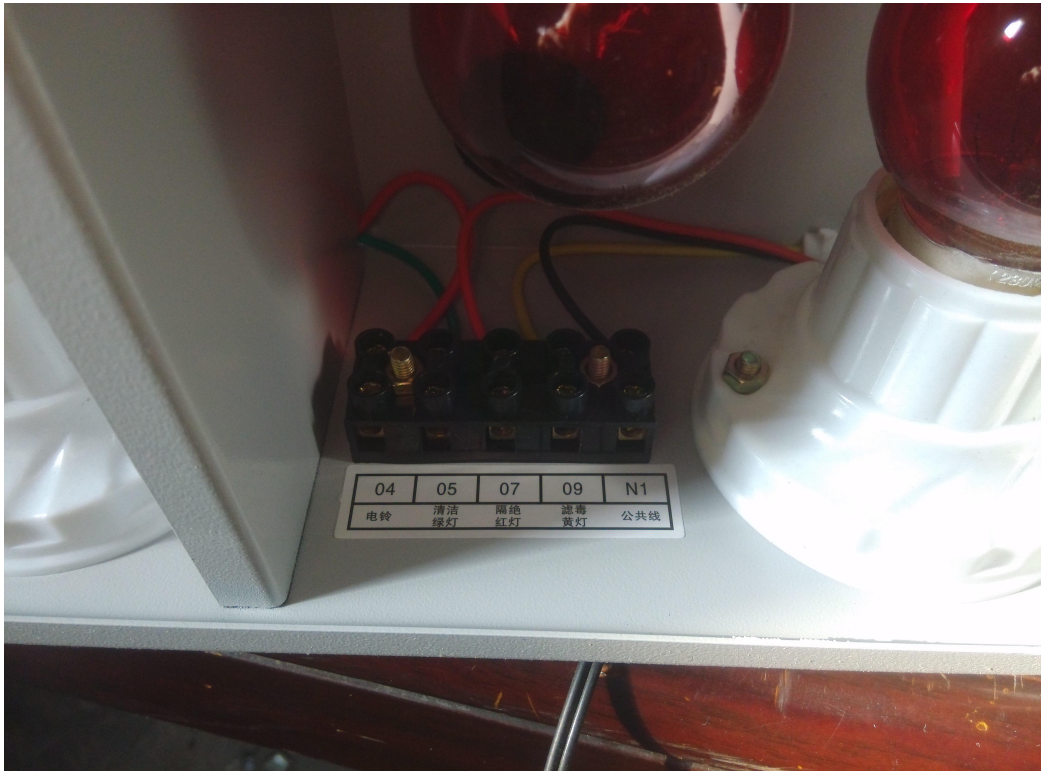
上图是通风方式灯箱的端子接线图标签
