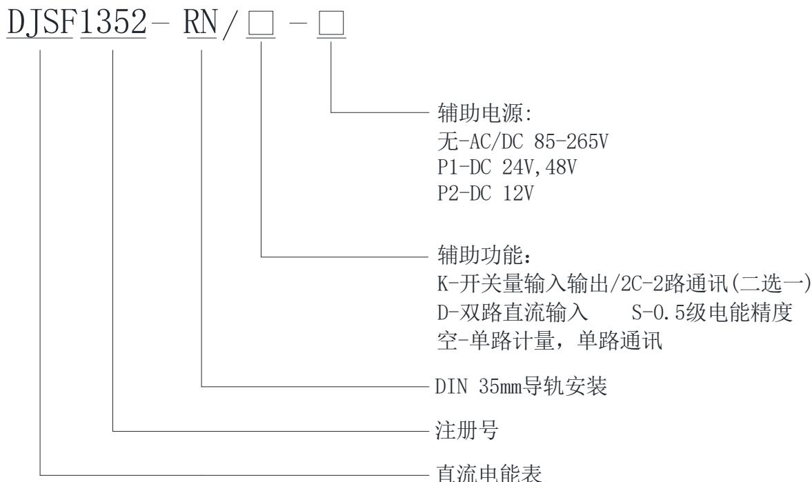
注：1.选配双路直流输入（D）功能时，如果电流通道均采用的是霍尔电流传感器输入，则需外配一个电源模块给第二路的霍尔传感器供电；如果未带D功能，则可使用电表内置电源。
