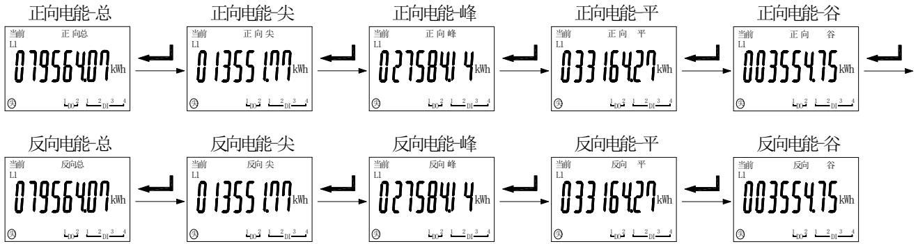
仪表开机后显示电流显示界面时，按右键切换到历史月电能查询显示界面后，按回车键切换显示：所查月正向有功电能（尖）→所查月正向有功电能（峰）→所查月正向有功电能（平）→所查月正向有功电能（谷）→所查月反向有功电能（总）→所查月反向有功电能（尖）→所查月反向有功电能（峰）→所查月反向有功电能（平）→所查月反向有功电能（谷）→查询电能的日期设置（年、月）。
