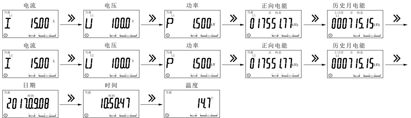
注：1、L1、L2 分别表示第一路、第二路直流输入，当未选配第二路直流输入时，L2 参数界面不显示；
