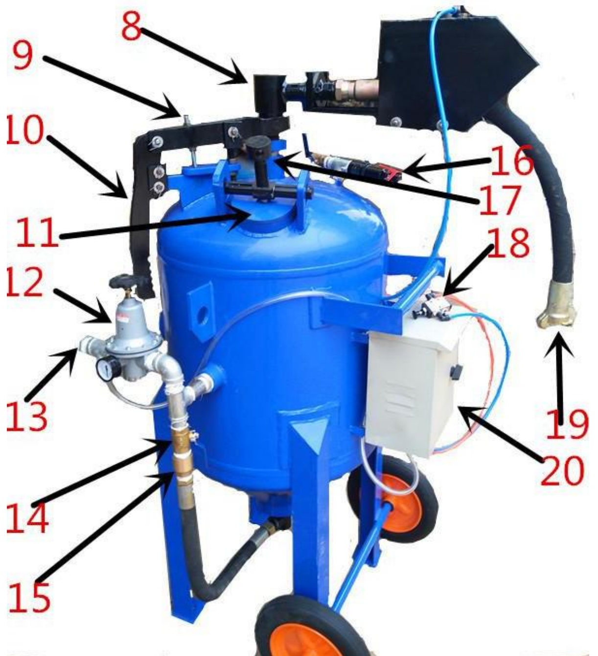
1、气缸；2、排气阀；3、吊装耳儿；4、加水口和溢水口；5、吹气阀；6、移动橡胶轮、7 控制彩管；8、出砂阀；9、砂量限位顶杆；10、砂量调节扳手；11、加砂口盲板；12、调压阀；13、进气接口；14:气阀开关；15.单向阀；16.安全阀；17.加砂口顶杆；18, 手拉阀开关；19, 砂管快接；20, 控制转换箱。
