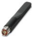
全向天线，2.4 GHz/5 GHz，增益：2.5 dBi/5 dBi，极化：线性，张角：h/v 360°/30°/16°，防护等级：IP68，接头：N ( 公 )，用于控制柜穿板式连接的相应连接电缆 ( 订货号2701402 )
