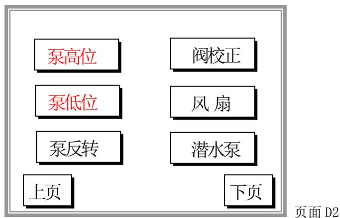
“泵低位”键，抽取试剂到计量管低位，“泵高位”，抽取试剂到计量管高位，“泵反转”排出计量管中液体；
