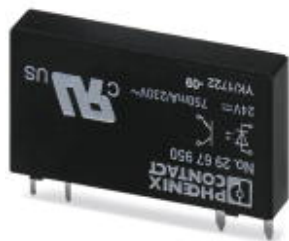
插拔式微型固态继电器，功率型固态继电器，1个常开触点，输入：24 V DC，输出：24 - 253 V AC/0.75 A
