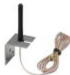
全向天线，2.4 GHz，增益：2 dBi，极化：线性，张角：h/v 360°/75°，防护等级：IP65，接口：RSMA ( 公 )，包括1.5 m连接电缆和用于壁式安装的安装托架
