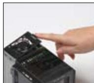
拆下变频器顶部盖板
