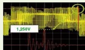
变频器直流母线电压: 625V
