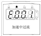
图 4-4 故障告警显示状态
