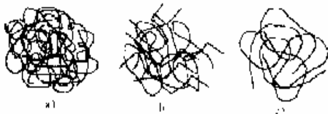
非结晶性材料随温度变化的形态
